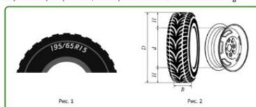
Последующая буква обозначает тип конструкции шины. В данном примере буква R означает, что шина радиальная, то есть нити каркаса в боковине шины расположены вдоль радиусов колеса. На всех легковых автомобилях применяются шины радиальной конструкции.
