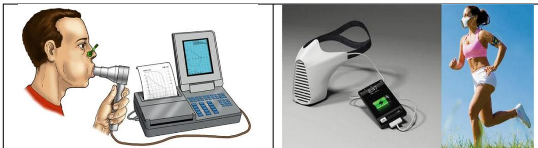
*Рис. 4. Цифровой спирометр*
